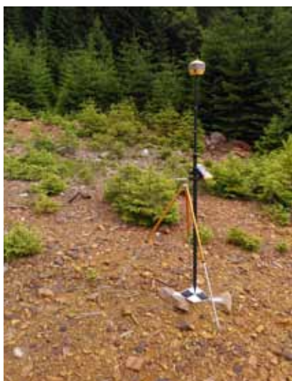
Obr. 3: Zaměřování vlíčovacích bodů pro vytvoření geometricky přesné ortofotomozaiky. Foto: Ondřej Lagner.
